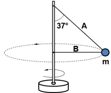
**2.a.-** Calcule la intensidad de la tensión en la soga B cuando la bolita gira con una rapidez de 6 m/s.
