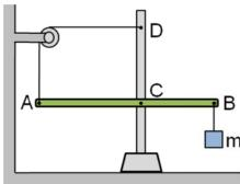
CE: El sistema de la figura está compuesto por una barra horizontal y homogénea de 50 kg, y una caja de dimensiones despreciables y de 10 kg. La barra está vinculada a un poste vertical por medio de un eje que la atraviesa en C, ubicado a 30 cm respecto de su centro de gravedad, y por medio de una soga ideal en su extremo A, que pasa por una polea fija ideal que la vincula en D. Dicha soga ejerce una fuerza de 150 N, y en esas condiciones el sistema permanece en equilibrio.
