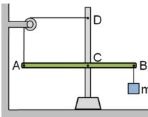
CE: El sistema de la figura está compuesto por una barra horizontal y homogénea de 87 kg, y una caja de dimensiones despreciables y de 4 kg. La barra está vinculada a un poste vertical por medio de un eje que la atraviesa en C, ubicado a 20 cm respecto de su centro de gravedad, y por medio de una soga ideal en su extremo A, que pasa por una polea fija ideal que la vincula en D. Dicha soga ejerce una fuerza de 160 N, y en esas condiciones el sistema permanece en equilibrio.
