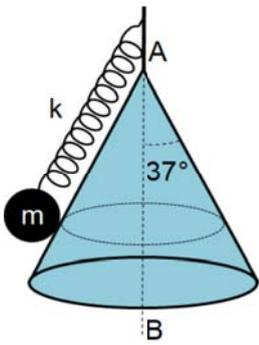
**DC.** Un cuerpo de **4,5 kg** cuelga de un resorte ideal de constante elástica  **$k = 500 \text{ N/m}$**  y longitud natural  **$l_0 = 15 \text{ cm}$** , y gira con velocidad angular constante alrededor del eje vertical AB, apoyado sobre la superficie cónica de la figura, describiendo siempre una circunferencia horizontal. El extremo superior del resorte está fijo a la cúspide del cono. Se desprecian todos los rozamientos.
