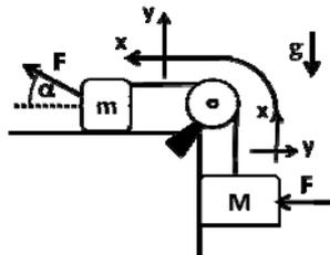
Sobre la masa  $m=5\text{kg}$ , apoyada en la superficie horizontal, se aplica una fuerza  $F$  que forma un ángulo  $\alpha=37^\circ$  con la vertical. Sobre la masa  $M=3\text{kg}$  apoyada en la pared vertical se aplica la misma fuerza  $F$  perpendicular a la pared. El sistema se encuentra en equilibrio.
