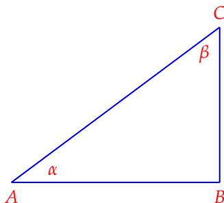
Por ejemplo, en la figura,  $\text{sen}(\beta) = \frac{\overline{AB}}{\overline{AC}} = \cos(\alpha)$ .
