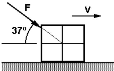
b) Cuando la velocidad de la caja es de 3 m/s se suprime la fuerza  $F$ . Determinar la distancia que recorrerá la caja hasta detenerse, a partir de ese instante.  $4,5 \text{ m}$
