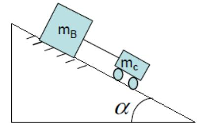
a) Realice los diagramas de cuerpo libre para el bloque y para el carrito. Si se apoyan los cuerpos sobre el plano inclinado sin velocidad inicial, calcule el máximo valor que puede tomar  $\alpha$  para que el sistema permanezca en reposo.  $14^\circ$
