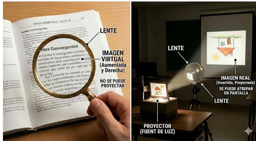
Ejemplos de imagen virtual y real con una lente convergente.
