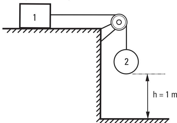
**2.25-** El sistema esquematizado en la figura parte del reposo; se puede despreciar la masa de la cuerda y la polea, y todos los rozamientos. La masa del bloque 1 es 22 kg, y la del bloque 2 es 28 kg.
