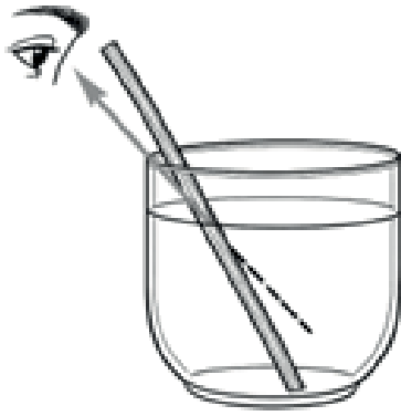
Figura 3-1: Posición aparente de un objeto, considerando la curvatura de los rayos de luz debido a la refracción a través de diferentes medios.
