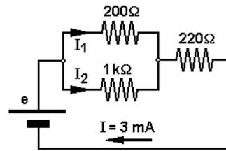
33) De acuerdo con el circuito esquematizado en la figura, obtener la potencia desarrollada en  $R_4$ .
