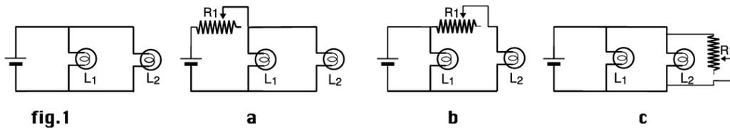
¿Cuál es la conexión correcta? ¿Cuál sería el efecto de las otras dos conexiones?
