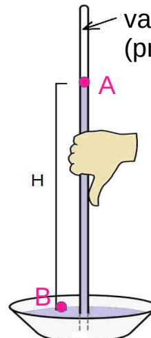
3) Luego de abrir el extremo sumergido, se observa que el mercurio (que antes llenaba el tubo), baja, pero no todo... queda a una altura H por encima del nivel del recipiente.
