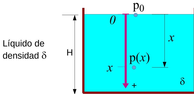
Tomamos un eje  $x$  con  $x = 0$  sobre la superficie superior, y positivo hacia abajo. Es decir que  $x$  indica la **profundidad** de un cierto punto cuya presión es  $p(x)$
