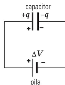
**Carga de un capacitor**
