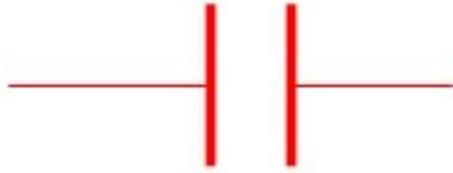
Donde las líneas verticales representan las placas del capacitor, y las líneas horizontales conductores que sirven para conectarlos con otro capacitor o con la pila (fuente). La idea en cualquier circuito con capacitores es poder determinar cuanto vale la carga y la ddp entre las placas en cada capacitor. Dependiendo de cómo están conectados podemos distinguir dos casos, en serie o en paralelo.
