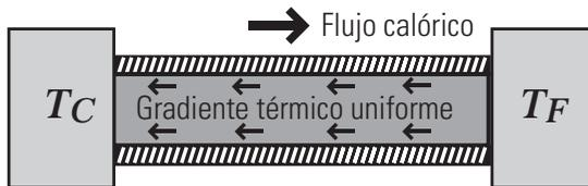
En la conducción estacionaria la temperatura en cada punto se mantiene constante en el tiempo. El gradiente a lo largo de la barra a través de la cual se conduce el calor es el mismo en todos los puntos; o sea, la variación de temperatura por unidad de longitud es en todos lados igual: yendo de izquierda a derecha la temperatura disminuye linealmente con la posición.
